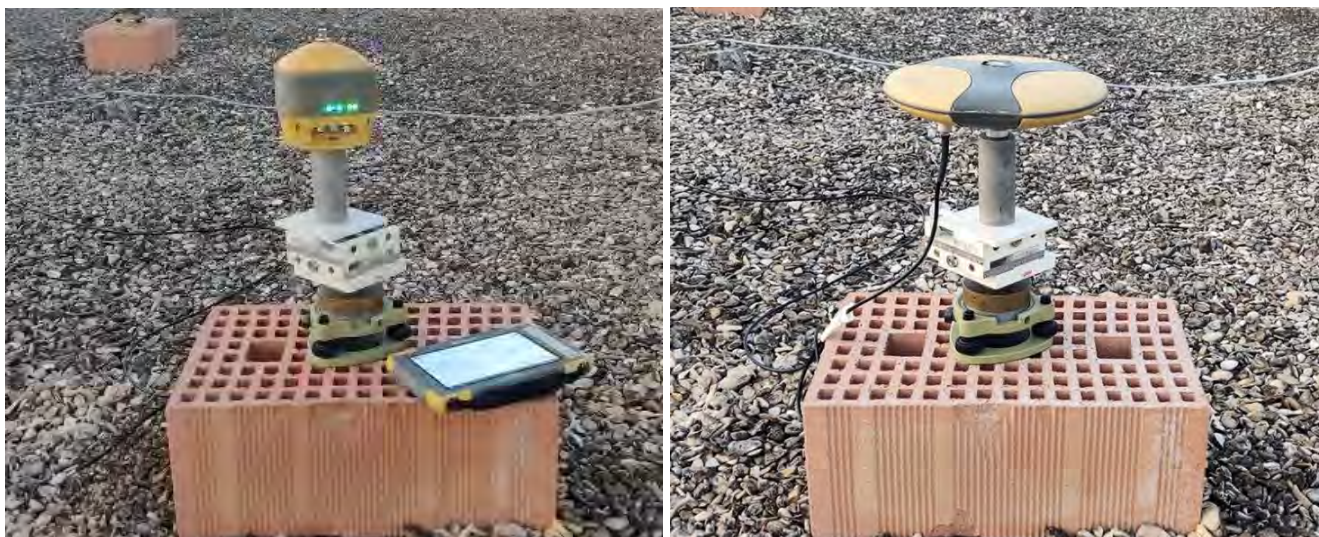
Figura 2. Ricevitori low-cost utilizzati: scheda C102-F9R (a sinistra), scheda C099-F9P (a destra).
