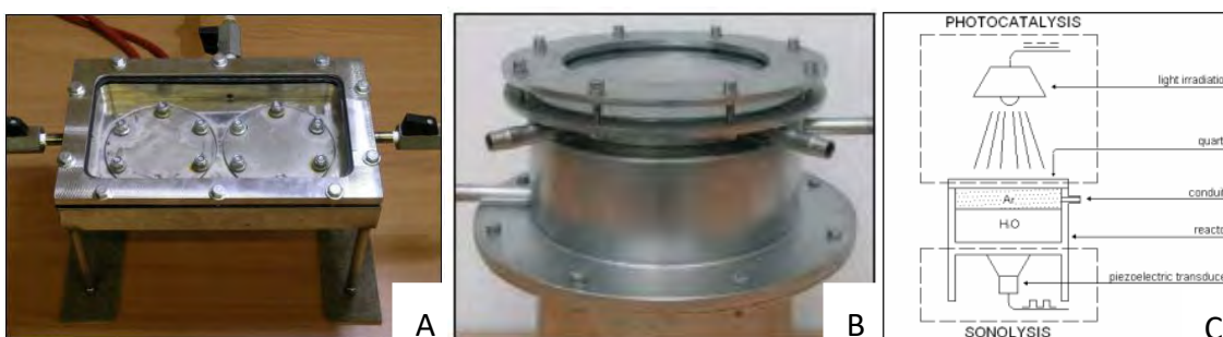
Figura 2. (A) Reattore rettangolare set-up 1, (B) Reattore cilindrico set-up 2, (C) schema dell'apparato sperimentale per entrambi i set-up.
