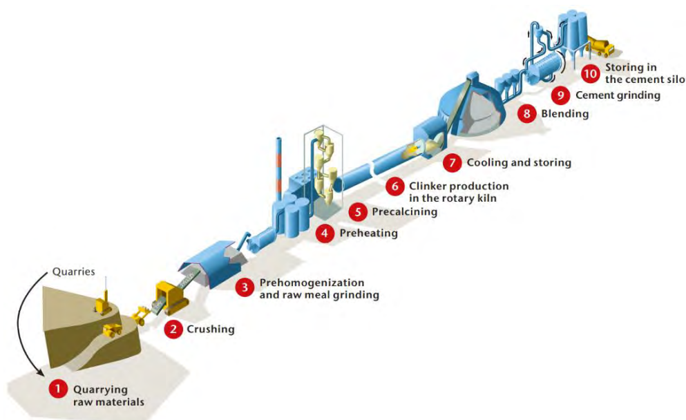
Figura 1. Fasi del processo di produzione del cemento [24].
