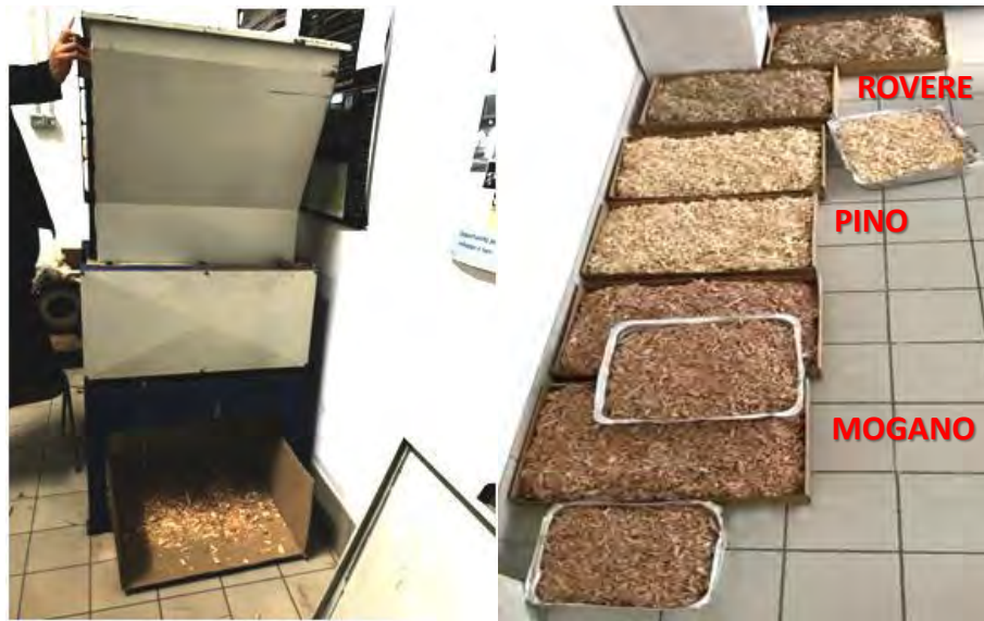
Figura 2. Cippatura del legno tramite un tritratore a martello.
