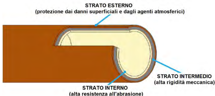
Figura 2 – Dettaglio della composizione del triplo strato del tubo Tripplo+. Fonte: Riccini S.r.l.
